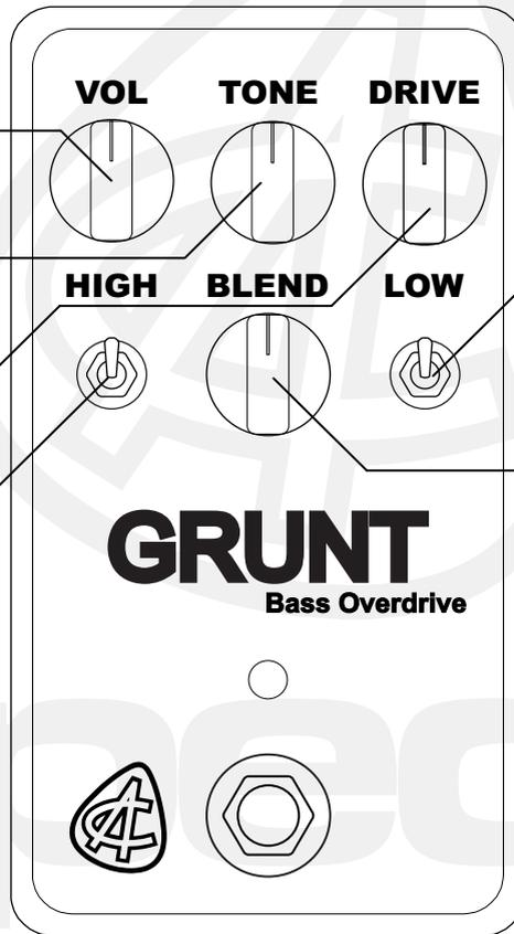
**LOW** - Este switch permite seleccionar tres niveles de graves en la señal con efecto: Con el switch al centro se tiene un nivel de graves ligero. Switch arriba, es el nivel de graves intermedio. Abajo, selecciona el nivel más alto de contenido de graves en la señal con efecto.
